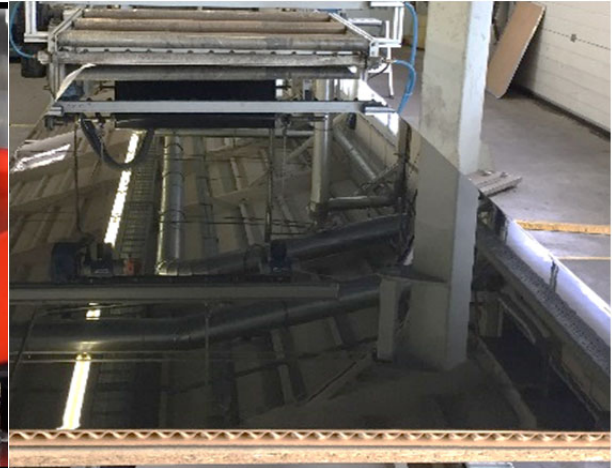
Beschichtung mit Rollenware auf einer Kalandrpresse
