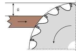
Die empfohlene Schnittgeschwindigkeit liegt bei 70 – 90 m/sec. Bei diamantbestückten Kreissägeblättern ist der obere Wert zu wählen. Es ist ein Vorschub pro Zahn von 0,07 – 0,15 mm anzustreben.
