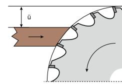
La vitesse de coupe recommandée se situe entre 70 et 90 m/sec. Dans le cas des lames de scie circulaire diamantées, préférer la valeur supérieure. L'avance par dent à viser est de 0,07 – 0,15 mm.
