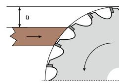
La velocità di taglio consigliata è di 70 – 90 m/sec. In caso di impiego di lame circolari diamantate bisogna scegliere il valore sopra indicato. Preferibilmente scegliere l'avanzamento per dente di 0,07 – 0,15 mm.
