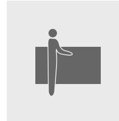
Während des Transport sollte die Dekorseite der Platte in Richtung des Transporteurs zeigen.
