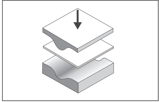
integrierte Einbauart angewendet werden, d. h. das Becken liegt ca. 2 mm unter der Plattenoberfläche zurück. Die so erzeugte „Schattenfuge“ lässt etwaige Farbabweichungen der zwei Oberflächen zurücktreten.
