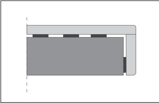
Verklebung: schwimmend mit Klebefugenstärke  $\geq 1\text{mm}$
