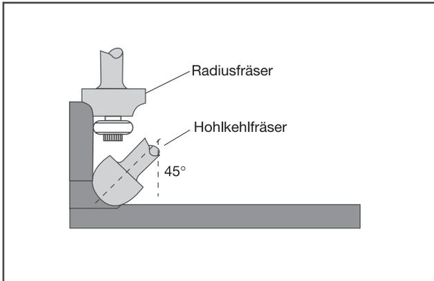
Das Verkleben mit Zwischenleiste im Falz ist erforderlich, um eine möglichst schmale und damit unauffällige Klebstofffuge zu erzeugen. Der Hohlkehlradius kann frei gewählt werden (es wird aus werkzeugtechnischen Gründen empfohlen: 6 – 11 – 14 mm). Beim Fräsen der Hohlkehlen kann mit der Spezialmaschine bzw. dem Fräser direkt in die Ecke eingetaucht werden. Lange Anschläge sorgen für präzises und sicheres Gleiten.
