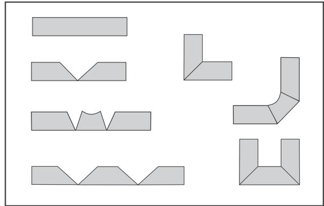
Besonders bei immer wiederkehrenden Kantenprofilen können über diese Methode relativ einfach und schnell Standardkanten und Hohlkehlen hergestellt und eine deutliche Zeit- und Kostenersparnis gegenüber der herkömmlichen Arbeitsweise erzielt werden.
