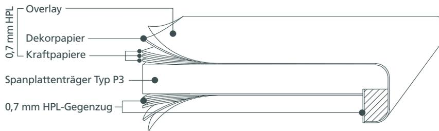
18 mm Qualitätsspanplattenträger Typ P3 (quellarm) nach DIN EN 312 mit 18 mm MDF-H Abkantung. Oberseite und vordere Kante belegt mit GetaLit (HPL) 0,7 mm (Flächenklebung PVAc), Vorderkante abgerundet und bis auf die Unterseite der Abkantung herumgezogen, Radius 10 mm. Rückseitige Kante geschützt (weiße Kante 0,3 mm mit EVA-Klebung). Rückseite der Abkantung ist durch Gegenzug geschützt. Dekor der Unterseite nach Werkswahl.
