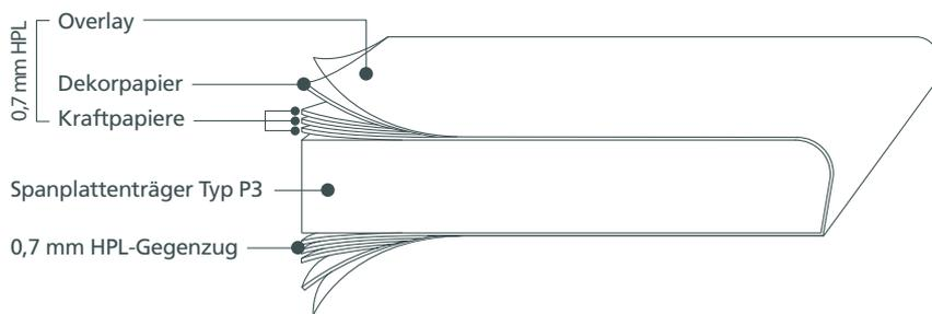
22 mm Qualitätsspanplattenträger Typ P3 (quellarm) nach DIN EN 312, Oberseite und vordere Kante belegt mit GetaLit (HPL) 0,7 mm (Flächenklebung PVAc), Vorderkante abgerundet, Radius 10 mm. Rückseitige Kante geschützt (weiße Kante 0,3 mm mit EVA-Klebung). Dekor der Unterseite nach Werkswahl.
