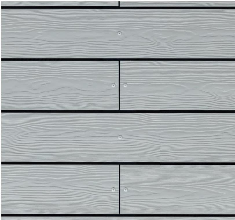
Bei der horizontalen Verlegung der Fassadenpaneele CEDRAL mit Fuge werden die vollkantigen Paneele ohne Überdeckung mit einer Fuge von 5 mm bis 10 mm verlegt.
