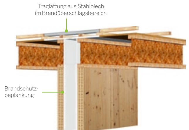
DA (L) 29 PH: DACHANSCHLUSS AN GEBÄUDETRENNWAND
