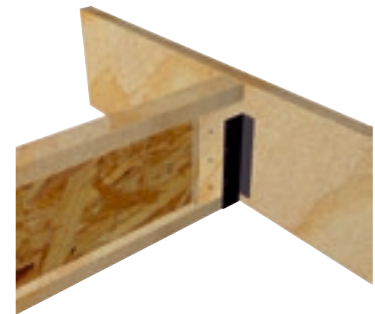
Stegverstärkung am Balkenschuh
