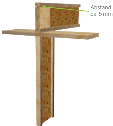
Stegverstärkung am Auflager
