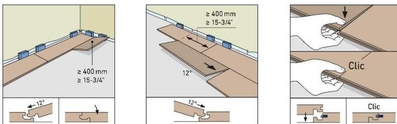
6. Die **letzte Reihe** muss sicherlich in der Länge angepasst werden. Beachten Sie dabei auch den Abstand zur Wand und schneiden Sie die Paneele entsprechend zu. Wenn das Paneel auch zu breit ist, dann muss es auch längsseitig angepasst werden. Dabei muss die blaue Feder an der Stirnseite entfernt und das Paneel an dieser Stelle mit dem Nachbarpaneel mit einem wasserfreien Kleber verleimt werden.
